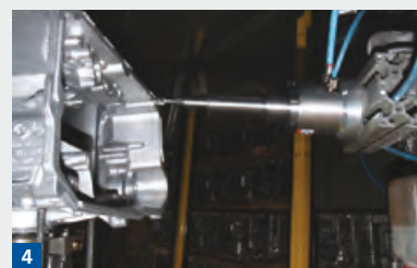
Abb. 4: Hier führt der Roboter das Bauteil, die Druckluftspindel ist fest installiert. Das spart Zeit, da das Bauteil nicht extra positioniert werden muss.
