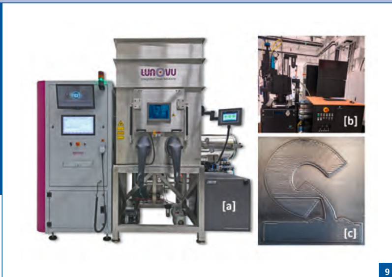
Abb. 9: a) LMD-System (Foto: www.das-design-plus.de , LUNOVU), b) Pulverbetтанlage (LPBF- Laser powder bed fusion) und c) Logo des Gießerei-Institutes, additiv gefertigt.
