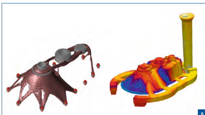
Abb. 6: Designvorschlag aus der Topologieoptimierung mit Altair Inspire (links) und Erstarrungssimulation mit MAGMASoft für den Getriebedeckel (rechts).
