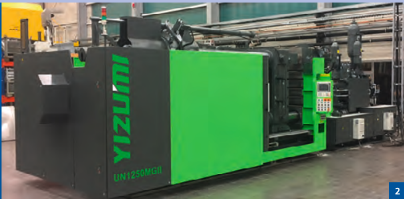
Abb. 2: Die im November 2020 gelieferte Yizumi UN1250MGII Thixomolding-Maschine
