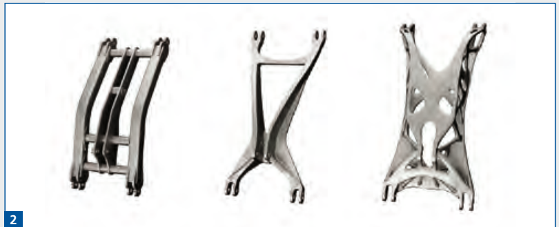
Abb. 2: Evolution eines Fahrwerksschwinge-Designs: Schweißkonstruktion (links), Gussausführung (Mitte), Designstudie zur weiteren Gewichtsoptimierung (rechts) Bildquelle: Amazone, voxeljet, ProGuss und Altair.
