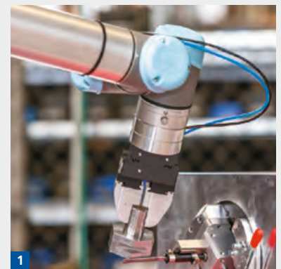
Abb. 1: Entgraten eines Bauteils mit einem BIAX-Druckluftfeiler. Dieser ist in den Ecken viel weniger aggressiv, als ein Frässtift.
