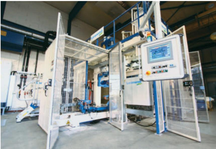
**Abbildung 2:** Loramendi Kernschießmaschine für anorganisch gebundene Formstoffe
