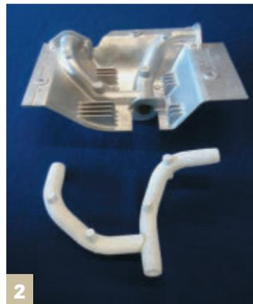
Abbildung 2: Druckgussteil mit Hohlstruktur und Salzkerne
