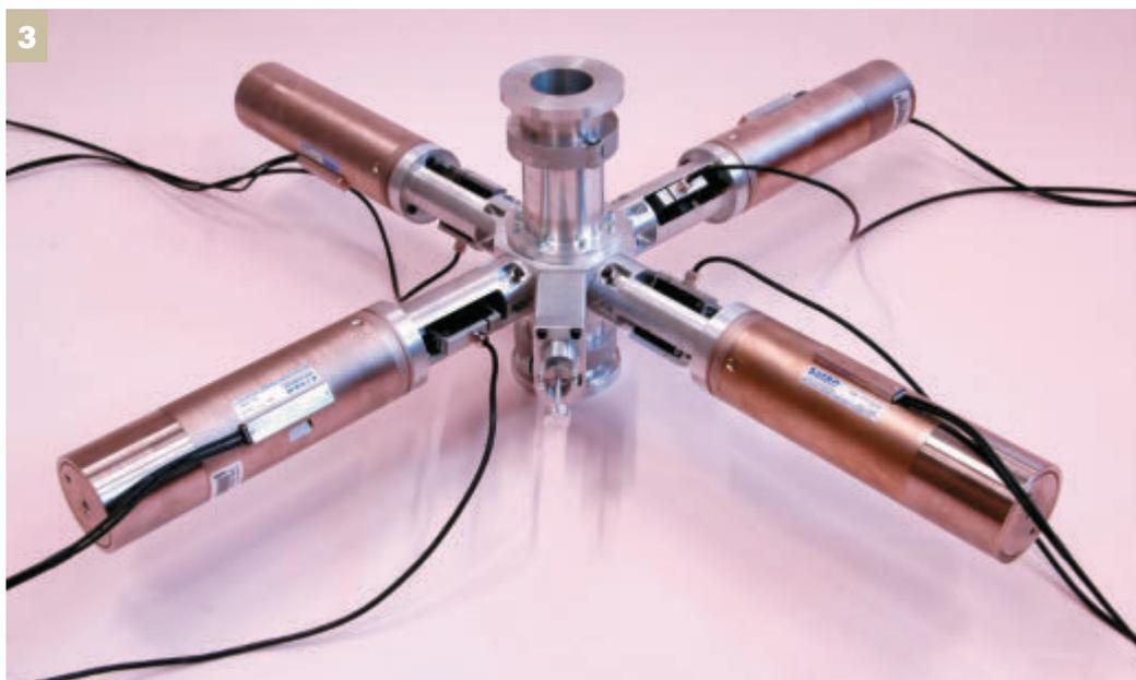
Abbildung 3: Messvorrichtung zur präzisen Bestimmung der Kernaushärtungs-Kinematik von Coldbox-Kernen
